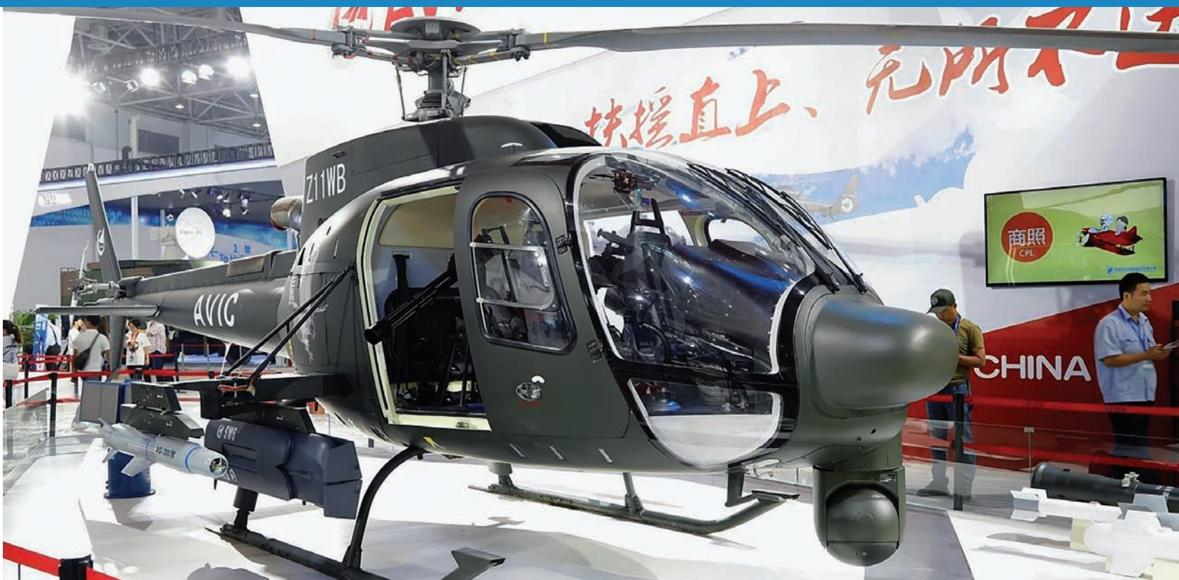
„Куанг“ – са шесткоцевним митраљезом, на носачима има противоклојну ракету и беспилотну лешелицу са склољеним крилима
